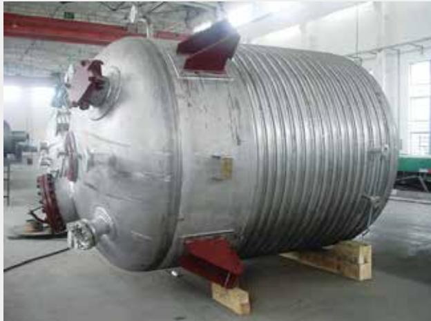
环氧乙烷装置用半盘管加热反应器
