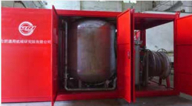
加油站地埋罐水射流清洗设备
