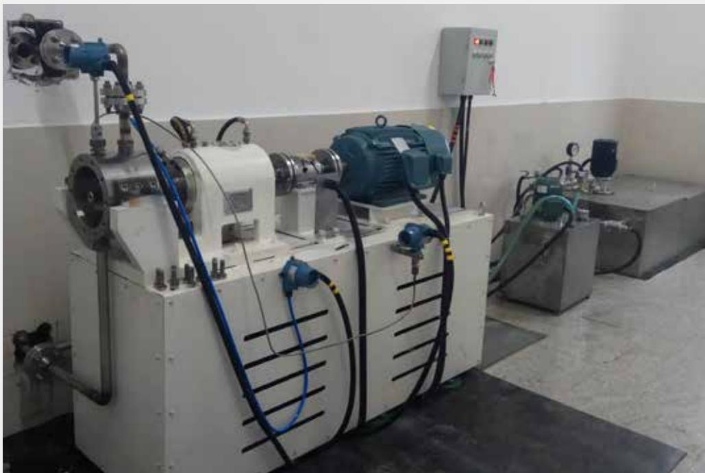
MST-T-400 型热油机械密封试验台
