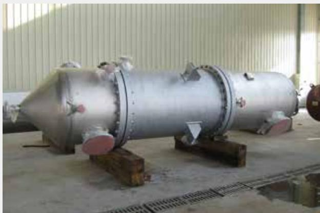
醋酸装置用羟化排气冷凝器
