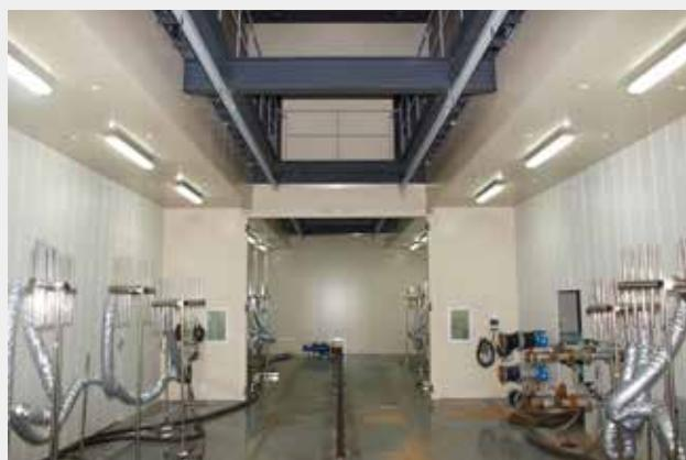
风冷冷水（热泵）机组试验装置
