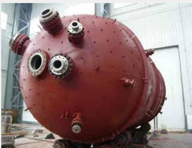
醋酸装置用锆钢复合板反应釜
