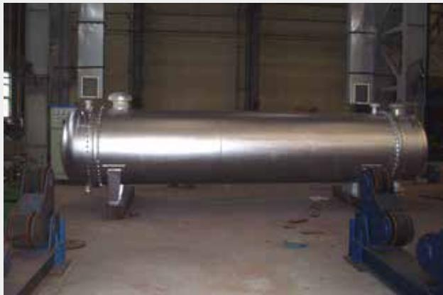
煤化工用波纹管换热器
