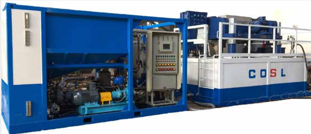
钻井泥浆罐自动化清洗成套装置
