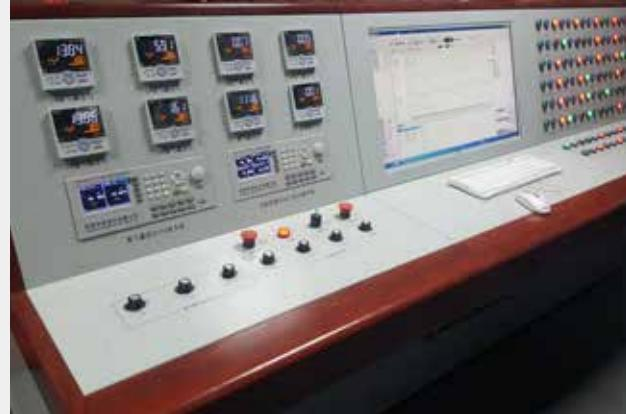
空气阀进排气性能试验装置
