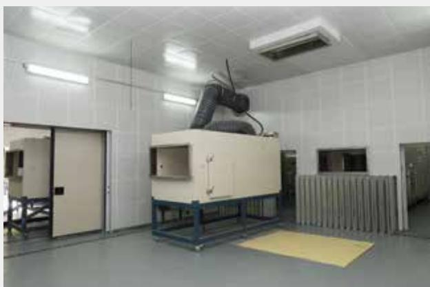
多联式空调 ( 热泵 ) 机组试验装置
