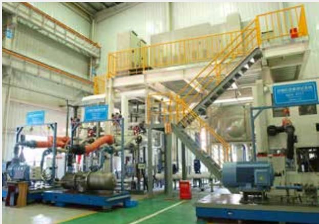
制冷压缩机性能试验装置
