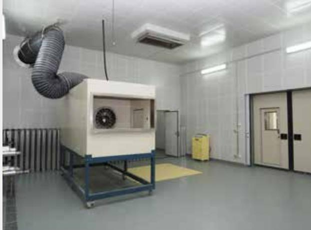
单元式空气调节机试验装置
