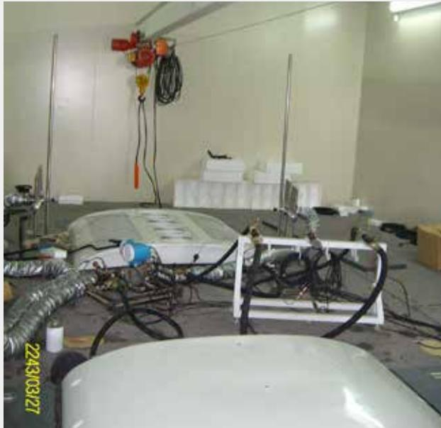
汽车空调压缩机性能试验装置
