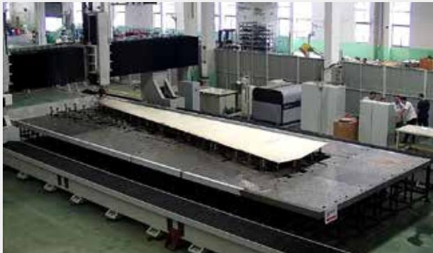
大型五轴联动超高压精密水切割加工装备
