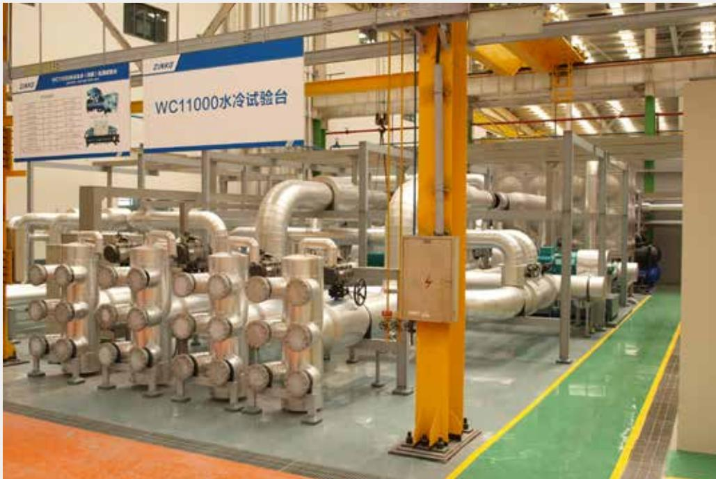
水冷冷水机组试验装置
