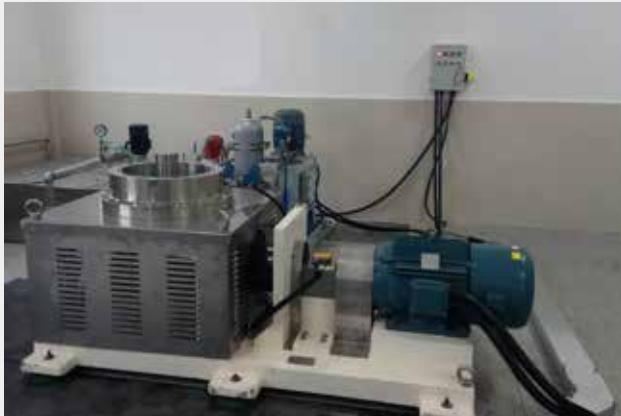
釜用机械密封试验台
