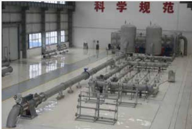
阀门流量流阻试验装置
