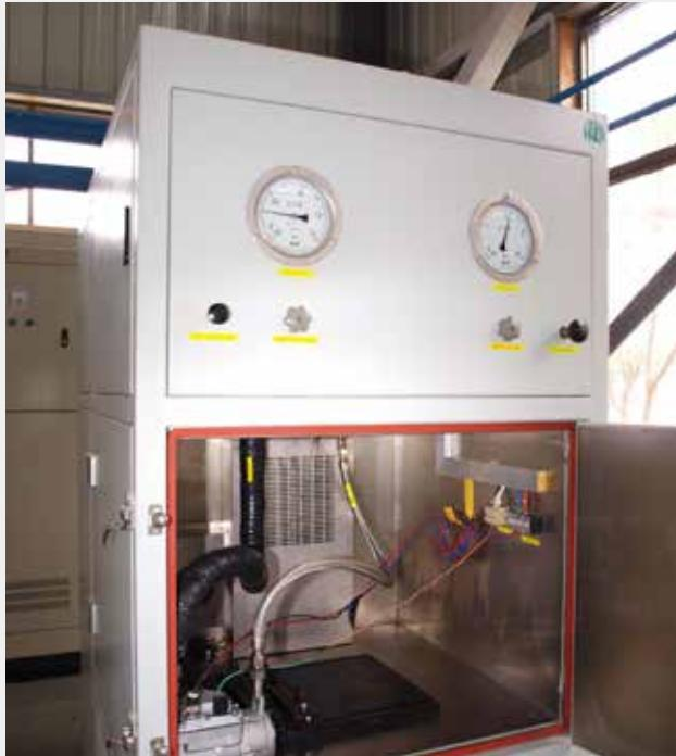
汽车空调压缩机耐久试验装置
