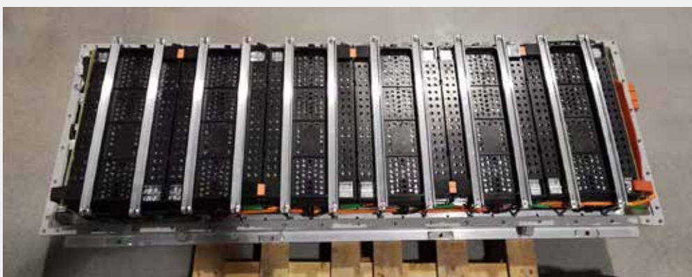
电池包 PACK 内部结构图
