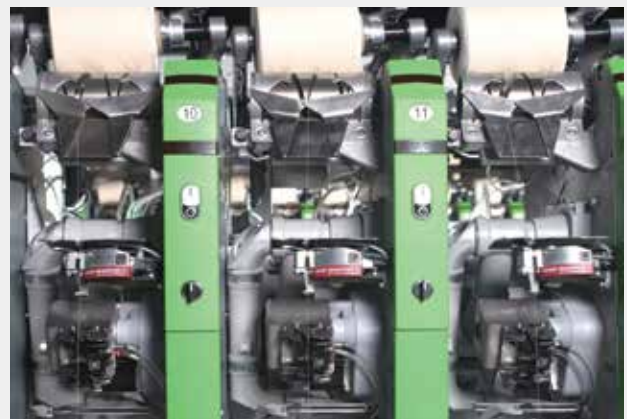
图 1.2.4 槽筒采用无刷电机同轴驱动
