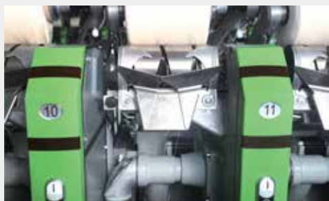
1.1.4 槽筒采用无刷电机同轴驱动
