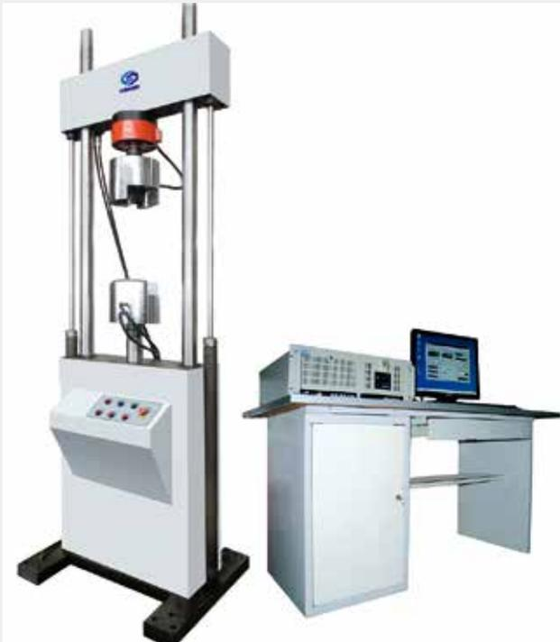
SDS 系列电液伺服动静疲劳试验机（双立柱）
