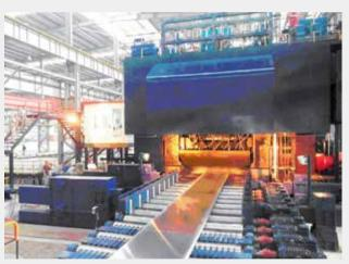
江苏大力神 3300+2800 铝板带热轧机 Jiangsu Hercules 3300+2800 aluminum plate hot rolling mill
