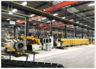
汽车纵梁冷弯成型生产线是专门为轧制各种汽车纵梁而设计制造的 Especially for roll forming various truck beams
