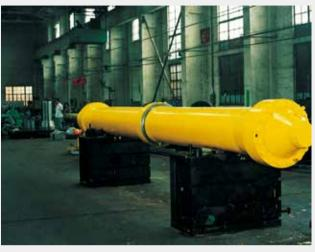
液压启闭机 The hydraulic hoister
