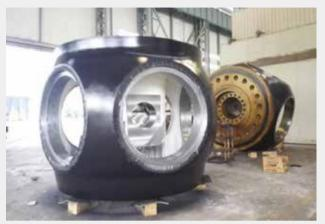
委内瑞拉 TOCOMA 216MW 水轮机转轮体 Venezuela TOCOMA 216MW Water Turbine Runner
