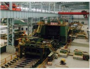
江苏银邦 4000mm 铝板轧机 Jiangsu Yinbang 4000mm aluminum plate mill
