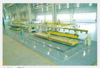
自动上、下料 Automatic Loading and Unloading
