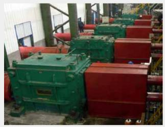
齿轮机座 Gear base
