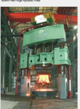
60 / 80MN 快速自由锻造油压机 60/80MN Quick Free Forge Hydraulic Press
