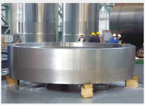
AP1000SG 核电管板 AP1000SG nuclear power tube plate
