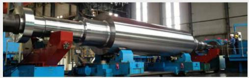
CAP1400 核电发电机转子锻件 (交货重量 262t, 锭型 650t) CAP1400 Rotor forgings of nuclear power generator (delivery weight 262t, ingot 650t)
