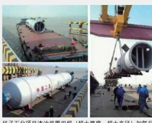
扬子石化项目渣油装置双超(超大厚度、超大直径)加氢反应器
