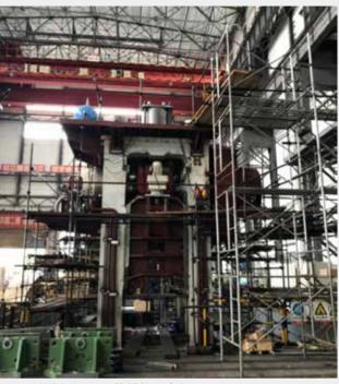
江西江锻新型 40MN 热模锻压力机 Jiangxi Jiangduan New Type of 40MN Hot Die Forging Press Die Forging Press
