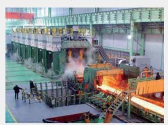
本钢 2300mm 轧机 2300mm rolling mill for Ben Steel
