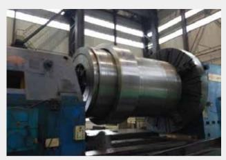
白鹤滩 1000MW 水电机组轴身锻件(交货重量 91.35t) Shaft body forging of Baihetan 1000MW hydro-power generator set (delivery weight 91.35t)
