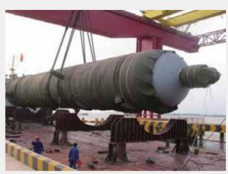
腾龙加氢裂化反应器 Tenglong Hydrogenation Cracking Reactor
