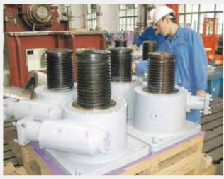
自升式海洋平台锁紧装置 Self-lifting sea-platform locking device
