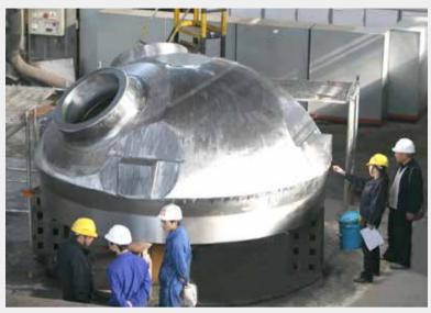
CPR1000SG 一次侧封头 CPR1000SG primary head
