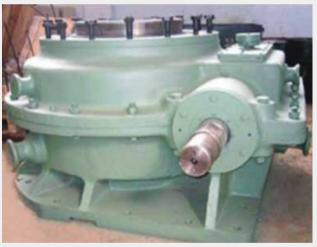
压下减速机 Press -down reducer
