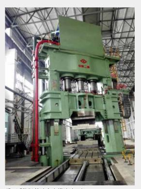
45 / 50MN 快速自由锻造油压机 45/50MN Quick Free Forge Hydraulic Press
