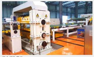
双曲拐飞剪机 Double Crank Rotary Shear
