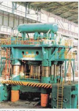
100MN 多向模锻水压机 100MN multi -ram hydraulic die forging press
