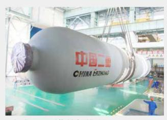
天津石化 1000 万吨炼油加氢裂化反应器
