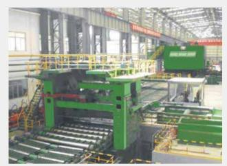
西南铝 4300mm 宽厚铝板热轧机组 Southwest Aluminum 4300mm heavy aluminum plate hot rolling mill
