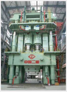
800M 大型模锻油压机 800MN Hydraulic Press
