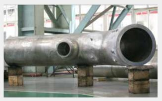
AP1000 主管道热锻 B AP1000 main pipeline hot section B
