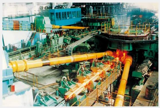
φ 177mm 管轧机 φ177mm tube rolling mill
