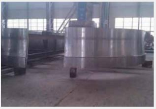
金安桥 600MW 水轮机分半式不锈钢下环 Jinanqiao 600MW Water Turbine Split-type Band of Stainless Steel
