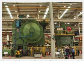
蒂森克虏伯发动机零部件(中国)有限公司 125MN 热模锻压力机生产线
