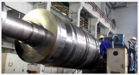
1000MW 发电机转子锻件 1000MW Grade Generator Rotor Forging
