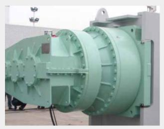
自升式海洋平台主升降齿轮箱 Self-lifting sea-platform main gearbox
