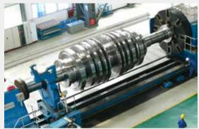
CPR1000 核电高压转子 CPR1000 Nuclear Power HP Rotor
