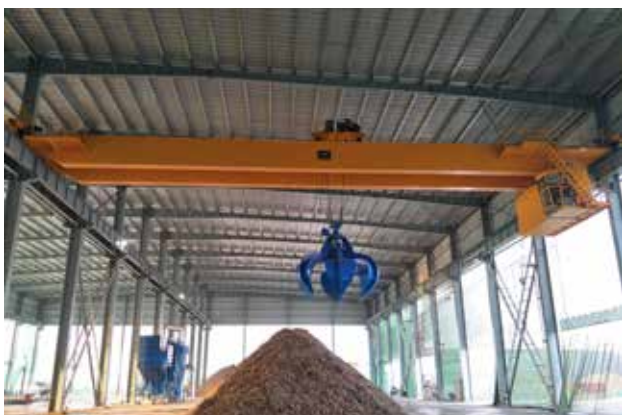
中电行唐生物质能热电工程—全自动散秸秆抓斗起重机 Zhongdian Xingtang Bio Power Project—Fully automatic crane
