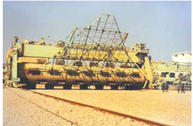
Qt800 · 30 滚筒式混匀取料机 QT800-30 drum type blending reclaimerr
