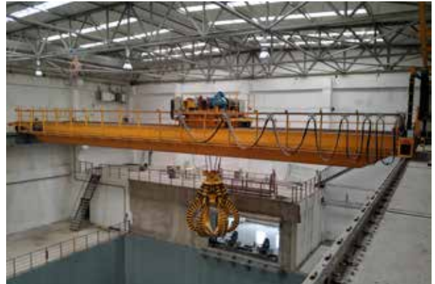
埃塞俄比亚莱比垃圾发电项目—高级半自动垃圾抓斗起重机 （非洲首座） Waste-to-Energy Project in Ethiopia—High Level Semi-auto bridge crane (Africa's first)
