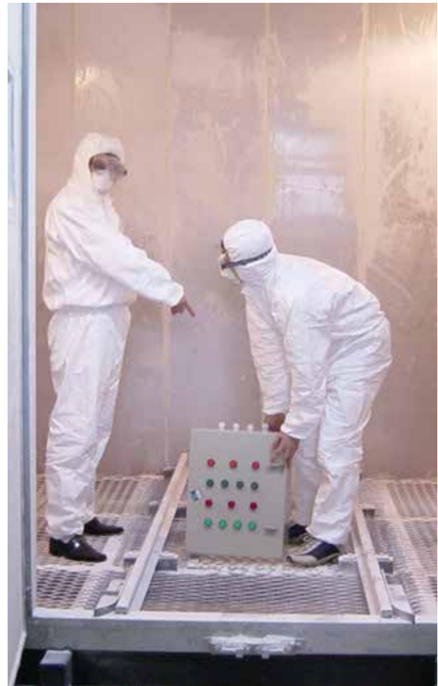
防尘试验 Dust test IP5X; IP6X
